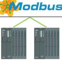
Licenze necessarie: 1 x **S7 OpenModbus/TCP RED PN** (6AV6676-6MB10-0AX0) In questo caso la gestione del collegamento ridondato è eseguita dai blocchi.
